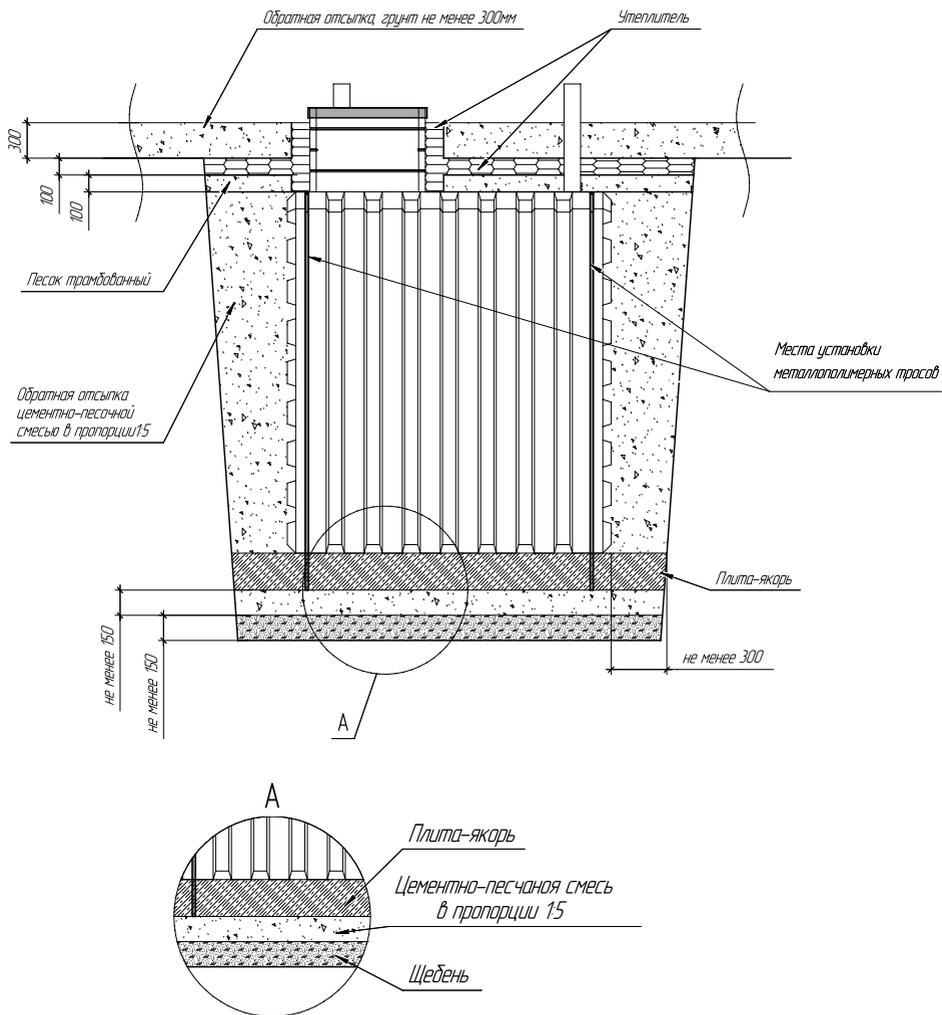
Схема монтажа погреба с верхним якорением
